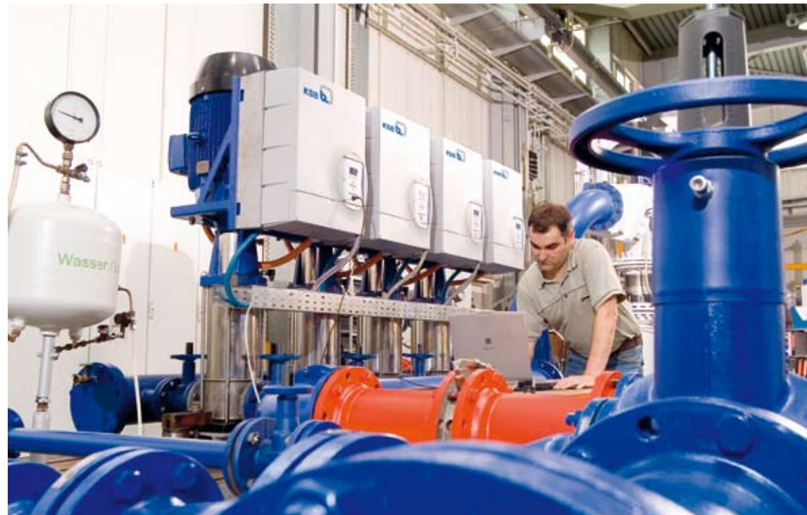
■ Die Pumpendrehzahlregelung PumpDrive ist für Anlagen mit bis zu sechs Pumpen und für eine Motorleistung bis 45 kW einsetzbar. Das Bild zeigt die Versuchsanordnung einer Mehrpumpenanlage im KSB-Werk Frankenthal mit vier Pumpen der Baureihe Movitec, die mit der Pumpendrehzahlregelung ausgerüstet sind.
