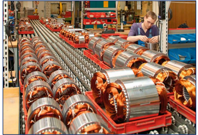
Abbildung 3 / Das seit 100 Jahren bewährte Prinzip des Asynchronmotors ist nach wie vor auch der perfekte Pumpenantrieb. Die künftigen Anforderungen an die Energieeffizienz wird diese Motorenbauart jedoch nur noch schwer erfüllen können.
